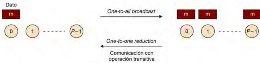
Figura 51. Esquema básico de las comunicaciones colectivas one-to-all y all-to-one .
